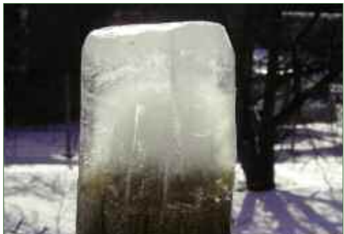
Проба воды из аэротенка. Это наглядный результат работы наших станций. В нижней части виден осевший активный ил. В верхней части — очищенная вода.
